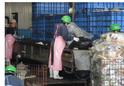
処分業者: 手作業で容器を分別
