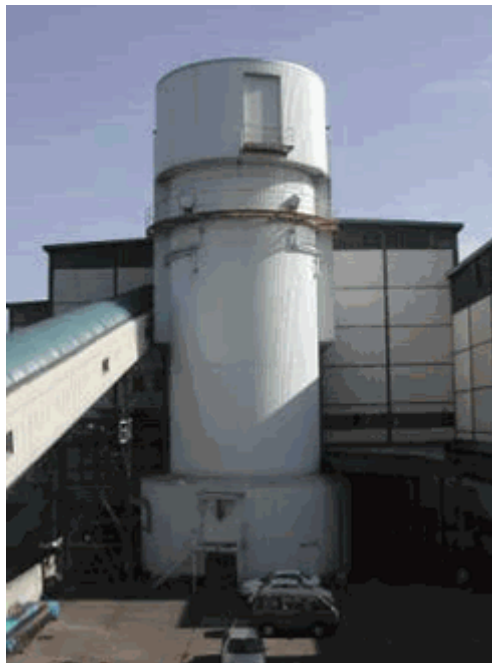
図表 糖分の抽出を行う浸出塔とタービン背熱の活用フロー
