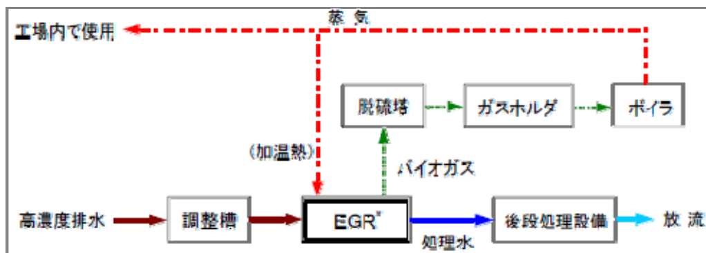
メタン発酵処理設備 概要図
