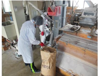
①玄蕎麦を粉碎機に投入し、実と殻を分離
