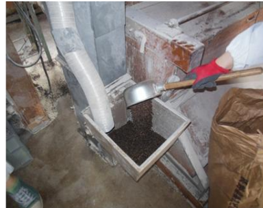
①玄蕎麦を粉碎機に投入し、実と殻を分離
