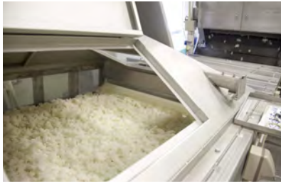
酒造りの要となる麹造りの工程。温度湿度を調節し約2日かけ蒸した米に麹菌を繁殖させる。
