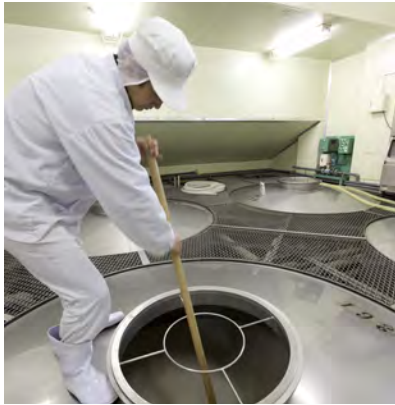
炭酸ガスを抜きながらもろみを攪拌する。発酵の状況を見守る杜氏の重要な仕事だ。
