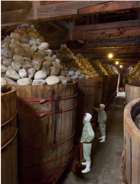
愛知県岡崎市にあるカクキュー八丁味噌。大きな桶の中に約6トンの味噌を、上に約3トンの石を職人が積み上げ、2年以上かけてじっくり仕込む。 www.hatcho-miso.co.jp
