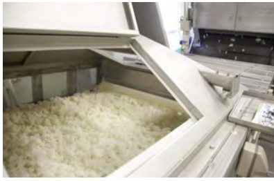
Élaboration du kôji , élément clé de la fabrication du saké. Pendant environ deux jours, température et humidité sont contrôlées pour faire proliférer les spores à kôji dans le riz cuit à la vapeur.
