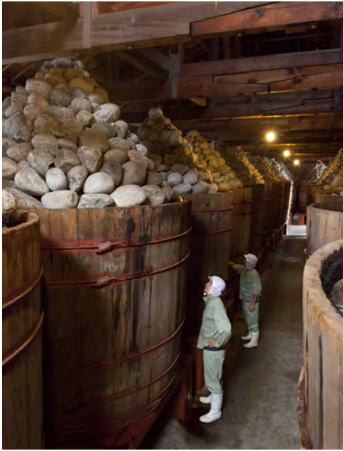
Chez Kakukyu Hatchô Miso à Okazaki dans la préfecture d'Aichi, le miso fermente plus de deux ans dans une cuve de six tonnes, sous environ trois tonnes de pierres. www.hatcho-miso.co.jp
