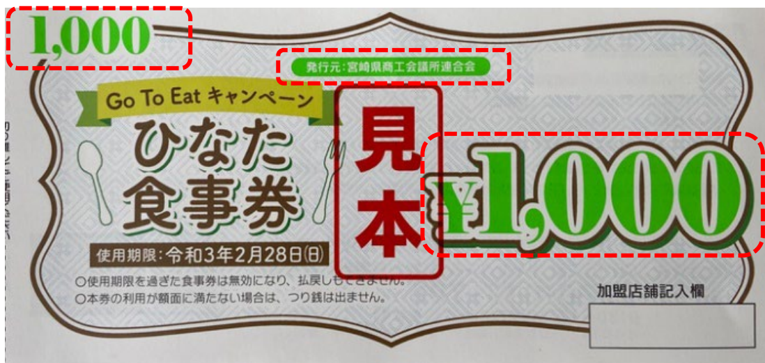
図 24 【食事券見本を写真撮影した画像：赤点線枠の3か所に蛍光発色インキを使用】
