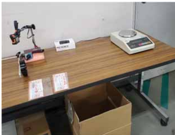
写真 3-1 (左) 厚さ検査、(右) 重量検査
