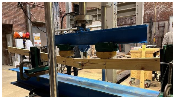
米国検査機関でのスギの強度試験 (令和5年11月、米国オレゴン州立大学)
