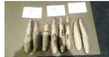
着荷状態の確認箱の上中下段での損傷状況確認
