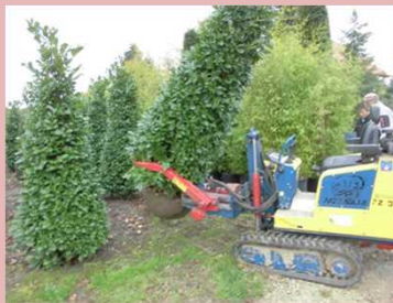
掘取機械の導入による省力化
