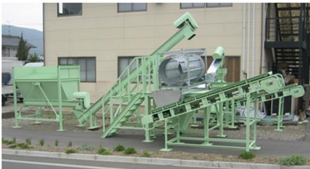
写真 4-6 磁選装置付きトロンメル
