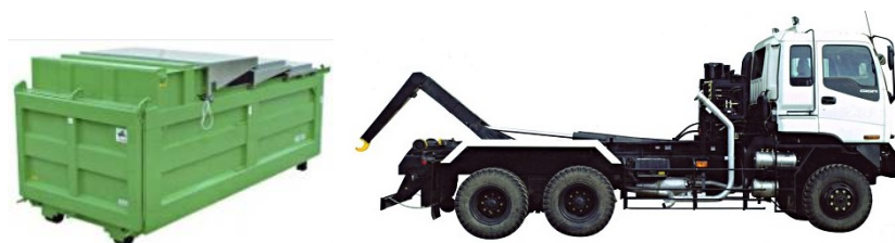
写真 収集用コンテナ(左)とアームロール車(右)
