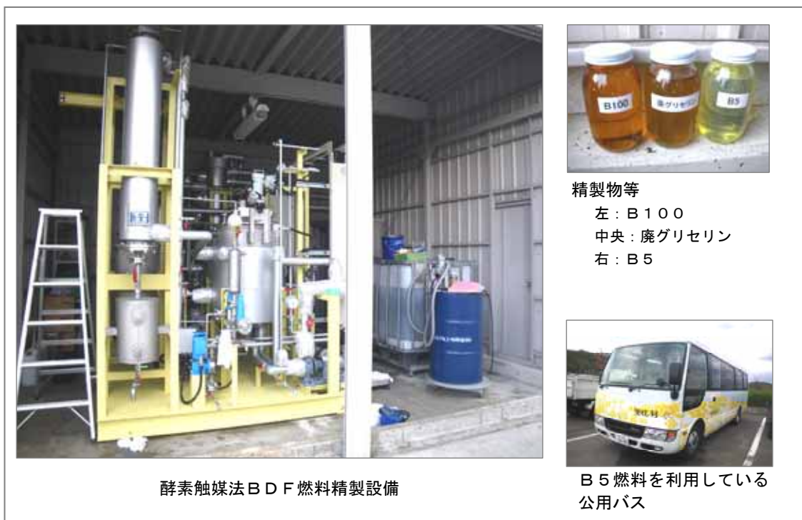
図 2-7 ウェルネスパーク五色に設置された酵素触媒法 BDF 精製設備
