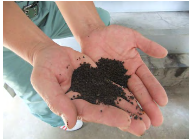
写真 2-11 衛生センター 乾燥汚泥
