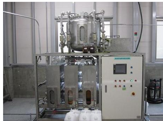
図 27 BDF 製造設備
