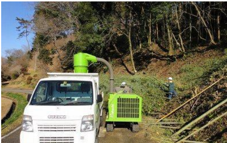
図 29 竹の破砕機(現場で粉砕、積込まで行える駆動型)
