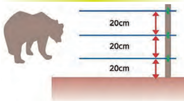
図2 電気柵複線タイプの設置方法
