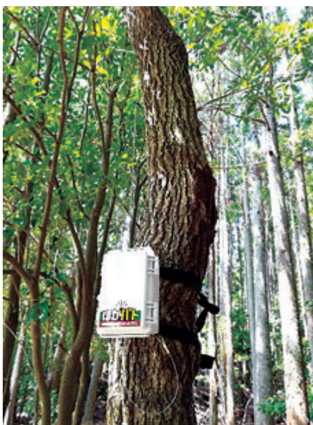
図4-1-3 わなの捕獲通知システム(左:子機、右:親機)
