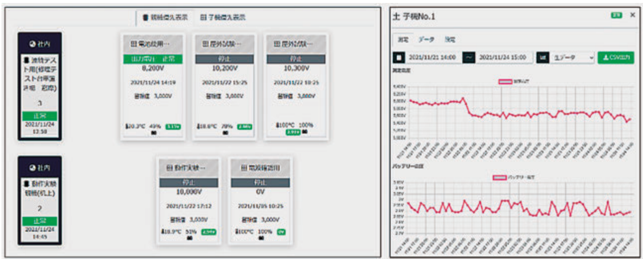
写真4-2 電圧の低下(右)を検知してスマートフォン等で閲覧ができる
