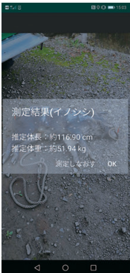
写真4-3-1 捕獲個体の大きさや体重、捕獲場所などを自動で測定、記録するアプリ画面
