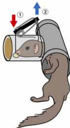
マングース捕獲用の筒式わなの構造
