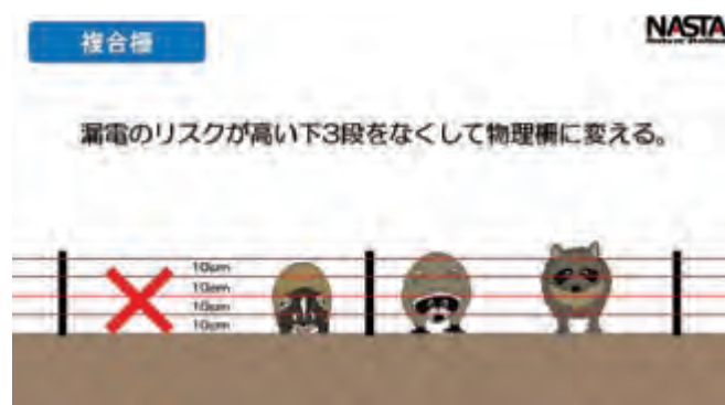
図11 電気さく下部の電気さく線を物理柵に変え漏電のリスクを抑えながら空間を面に変える。
