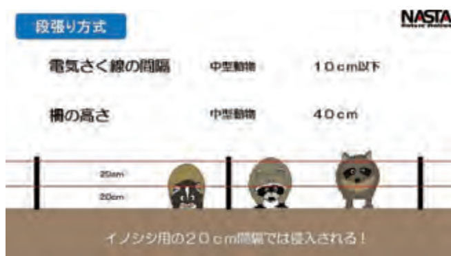
図5 電気柵は電気さく線を段上に張る段張り方式が一般的。電気さく線の間隔はイノシシ用の20cmでは広すぎる。
