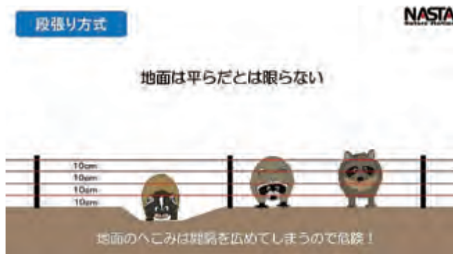
図7 地面にへこみがあると地表面と一段目の電気さく線との間隔が広がるので侵入される。
