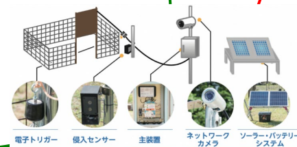
電子トリガー 侵入センサー 主装置 ネットワークカメラ ソーラー・バッテリーシステム
