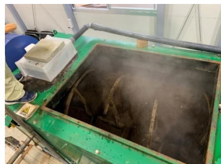
導入された減容化処理施設 処理槽内の様子
