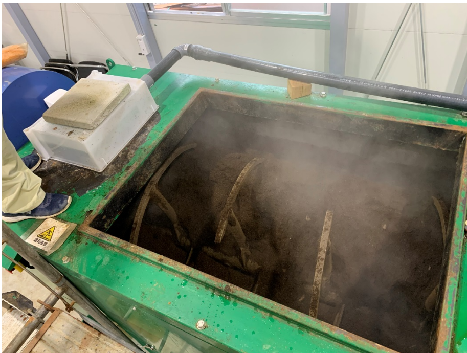
図 5. 処理槽内にはオガクズが入っており、スクリューで攪拌している
