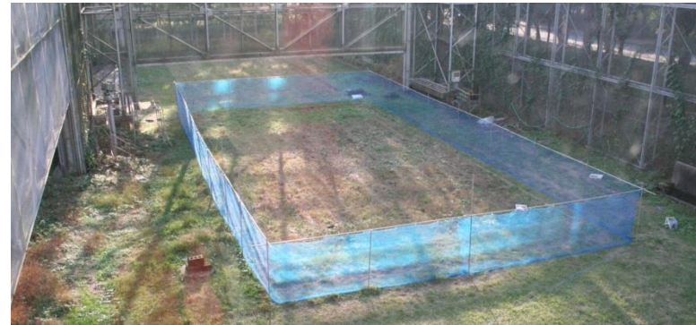
テグス間隔とカラスの行動の関係を大型ケージで試験
