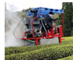
蒸気式防除・除草兼用機
