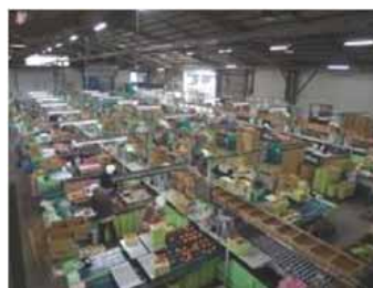
西部トマト選果場 (通称：西部館) ・大玉選果機 3 条 (既存 2 条) ・光センサー 3 台 ・年間計画：2,767t
