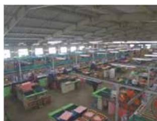
南部トマト選果場 (通称：南部館) ・大玉選果機 5 条 ・光センサー 5 台 ・年間計画：6,133t ・小玉選果機 1 系列 ・光センサー 3 台
