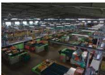
中央トマト選果場 (通称：中央館) ・大玉選果機 8 条 ・光センサー 8 台 ・年間計画：10,100t
