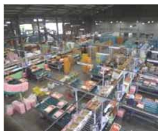
北部野菜果実選果場 (通称：北部館) ・大玉選果機 4 条 (既存対応) ・光センサー 4 台
