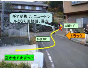
今回の事例は、田植機であったが、我々の過去の調査でも、運搬車のギアが道路の振動で抜け下り坂を暴走した事例や、モノレールで下っている時に振動でギアが抜け、40°以上ある急斜面を墜落するように激走、最終地点に激突、死亡などの事例を見聞きしている。このように、走行中の振動や、ちょっと触れただけでギアが抜けるような農業機械があるが、一般車両では考えられないことである。ぜひ、このギアの抜けやすさについても、厳しい基準を設けてもらいたものである。
