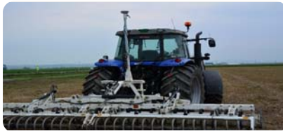
RTK-GNSSレーザーレベラーによるほ場均平作業
