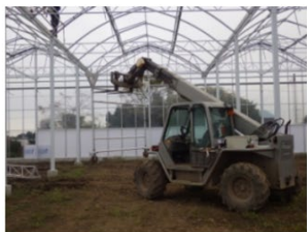
クレーンとフォークリフト両方の機能を併せ持つテレトラック
