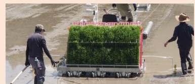
▲専用の機械で紙マルチを敷き、田植を行う
