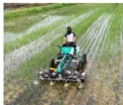
乗用型水田除草機による除草
