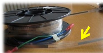
テープヒーター
