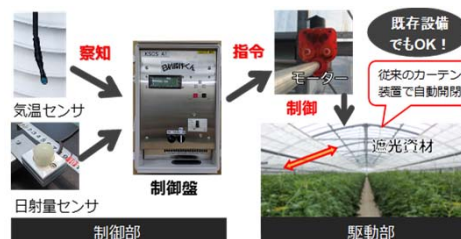
自動調光システムのしくみ
