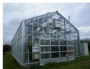
図1 温暖化再現ハウスの外観(長野地方気象台の月毎の平均気温に2℃加算)
