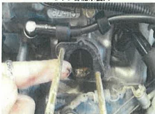
エンジン部泥水侵入
