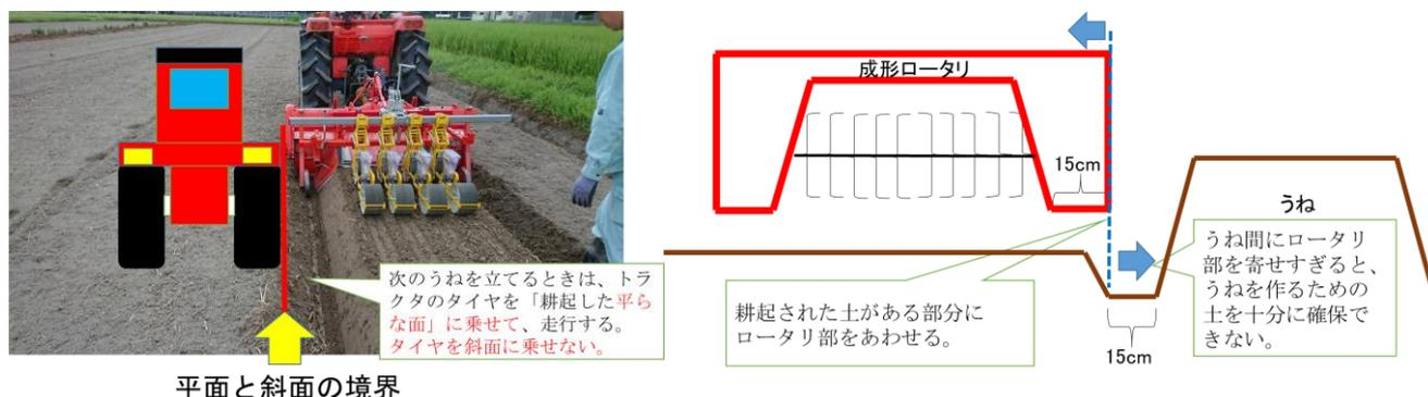
※トラクタの輪距が成型機の幅より広いと、タイヤが斜面に落ちてトラクタが傾き、うねの形が乱れるため、輪距が成型機の幅より狭いトラクタを用いる。
