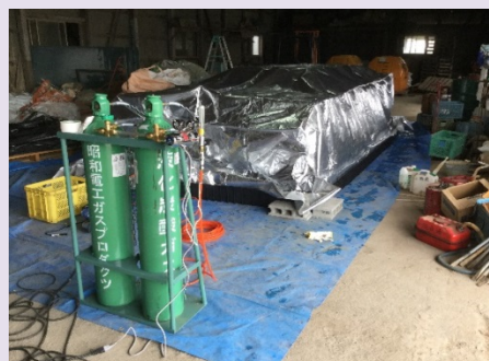
高濃度炭酸ガス処理装置
