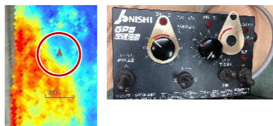
施肥マップ（写真左）。赤色の箇所ほど可給態窒素の量が少ない。赤丸がトラクターの現在地を示しており、施肥マップの色に応じてコントローラー（写真右）を調整することで可変施肥が行える。
