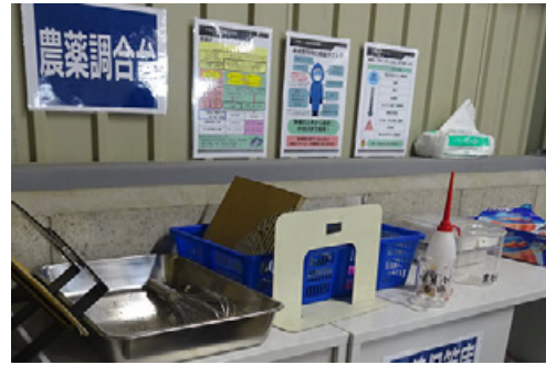
図 3 農薬調製専用の台と、計量機器 (提供：埼玉県)
