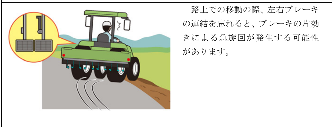
図2 乗用型トラクターの片ブレーキ
