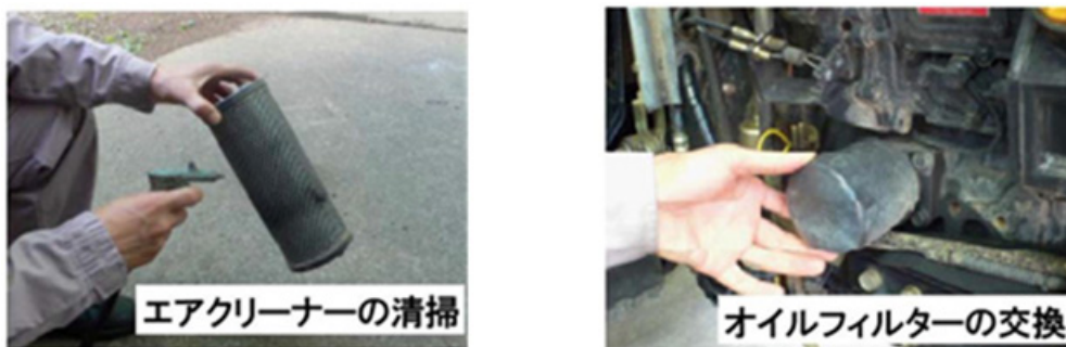
図3 エンジンの保守点検の例（トラクター、コンバイン等）
