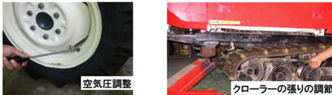
図4 走行部の保守点検の例（トラクター、コンバイン等）
