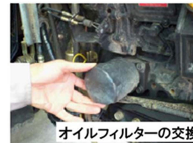
図3 エンジンの保守点検の例（トラクター、コンバイン等） 出典：農林水産省「農業機械の省エネ利用マニュアル」
