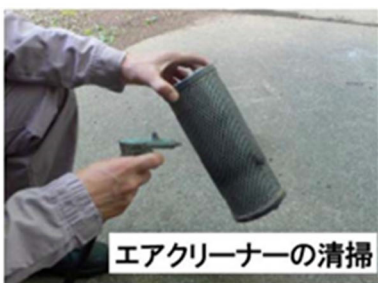
図3 エンジンの保守点検の例（トラクター、コンバイン等） 出典：農林水産省「農業機械の省エネ利用マニュアル」
