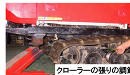
図3 エンジンの保守点検の例（トラクター、コンバイン等） 出典：農林水産省「農業機械の省エネ利用マニュアル」
