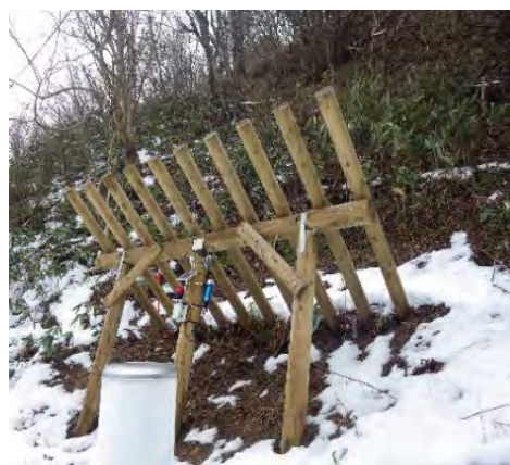
雪崩・落石の計測柵
