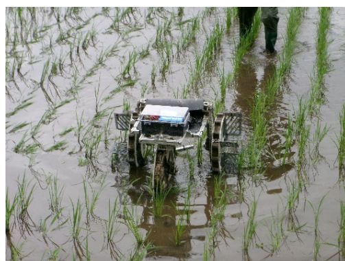
開発中の除草用小型ロボット
