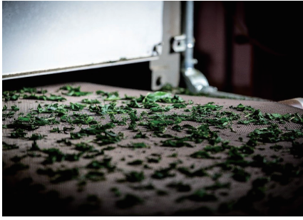
食品安全マネジメントシステム規格「FSSC 22000」の認証を取得した工場で、抹茶の原料である碾茶（てんちゃ）を乾燥させているところ。
