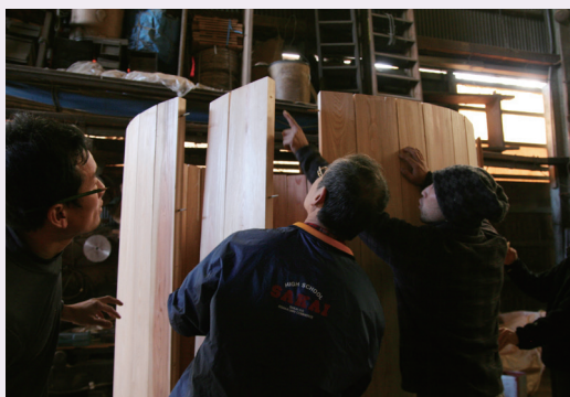
板状になった木材の接地面から角度を付けて削り、竹くぎで合わせながら円形に組み立てていく。
