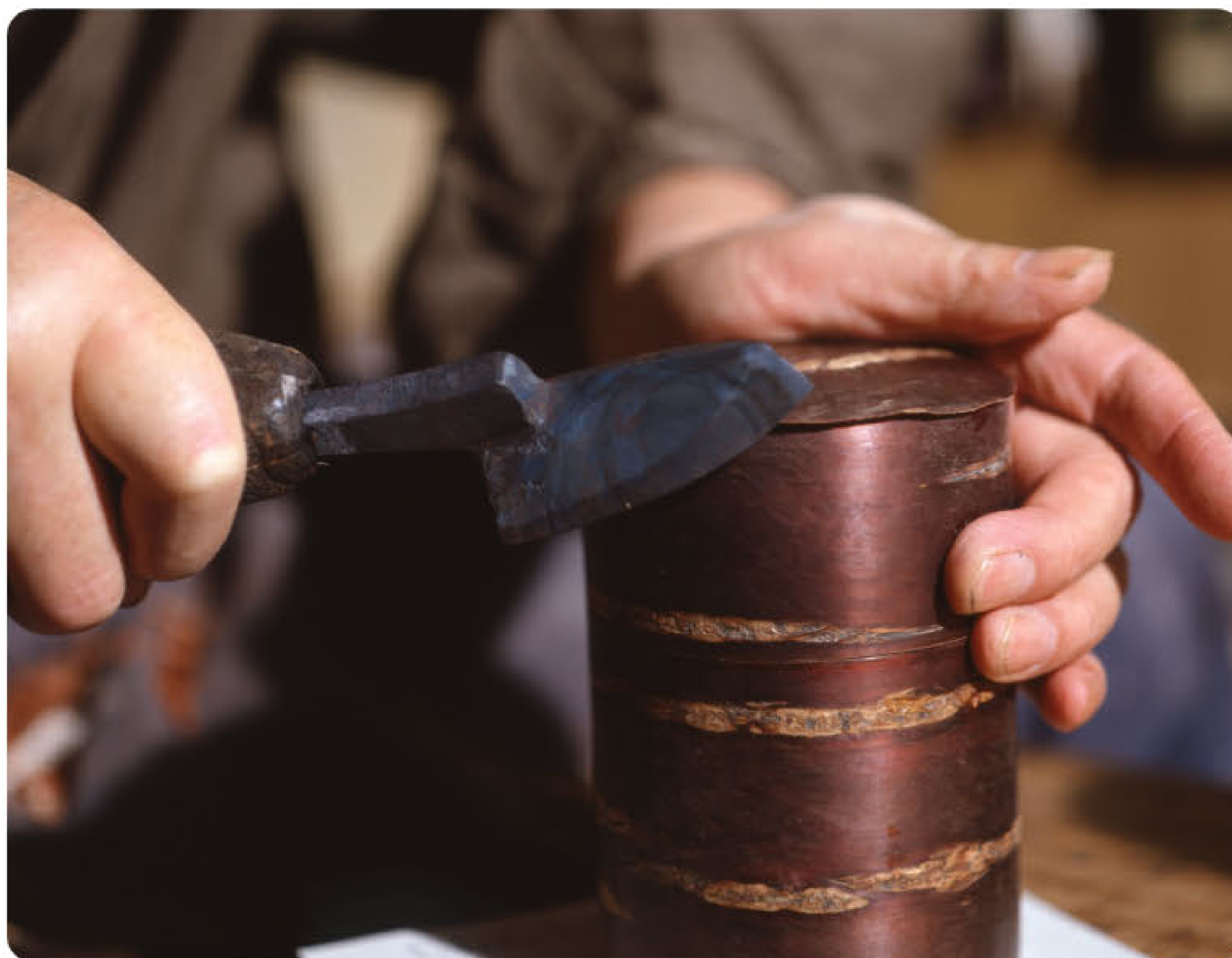
樹皮を貼り付ける工程で使用される、樺細工専用の金ゴテ。熱した金ゴテを駆使して樹皮に丸みや角度を付け丁寧に貼り付けていく。
