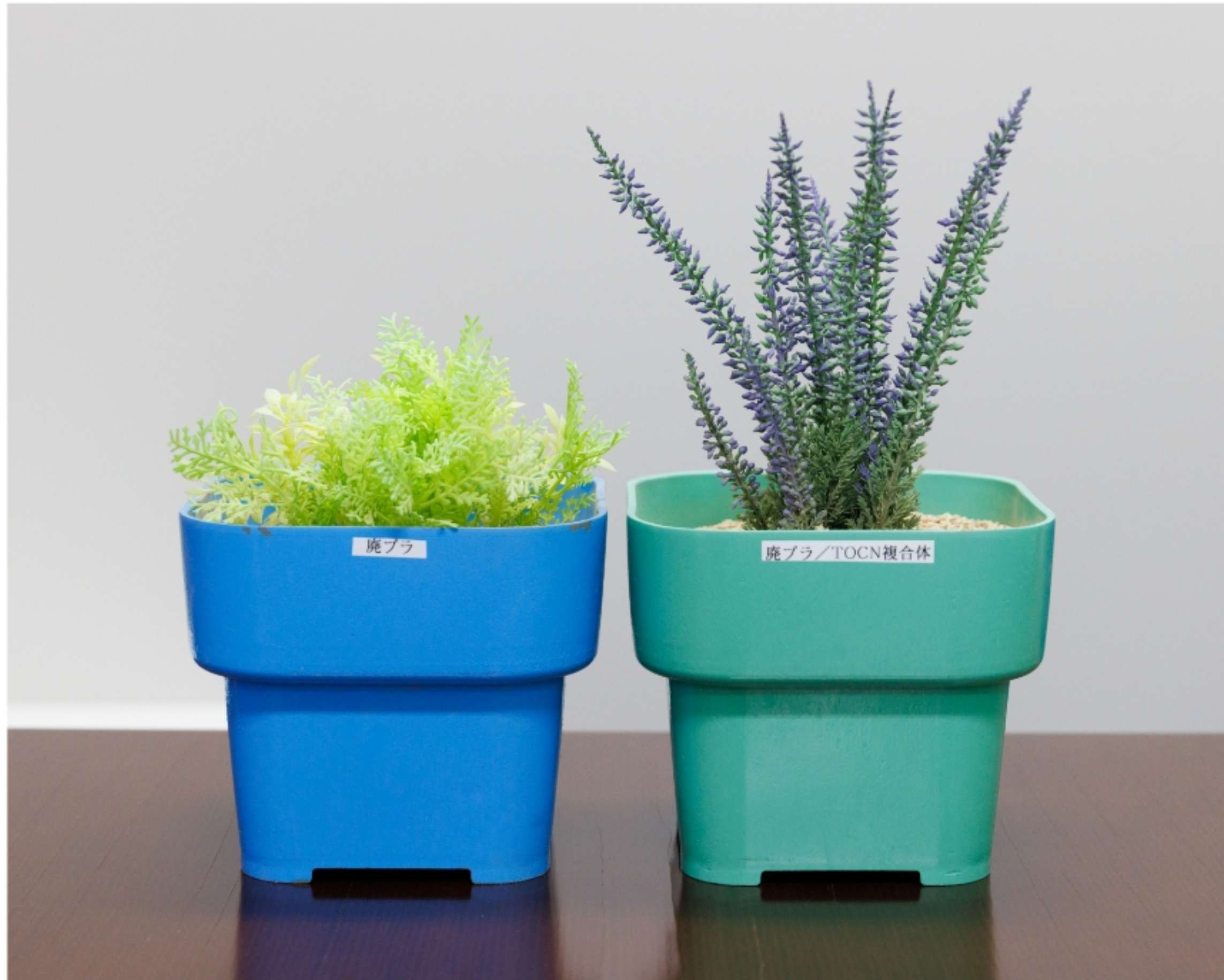
ポリエチレン製の鉢植え用ポット（左）と、CNFを添加したナノナノ複合材料で作ったポット（右）。
