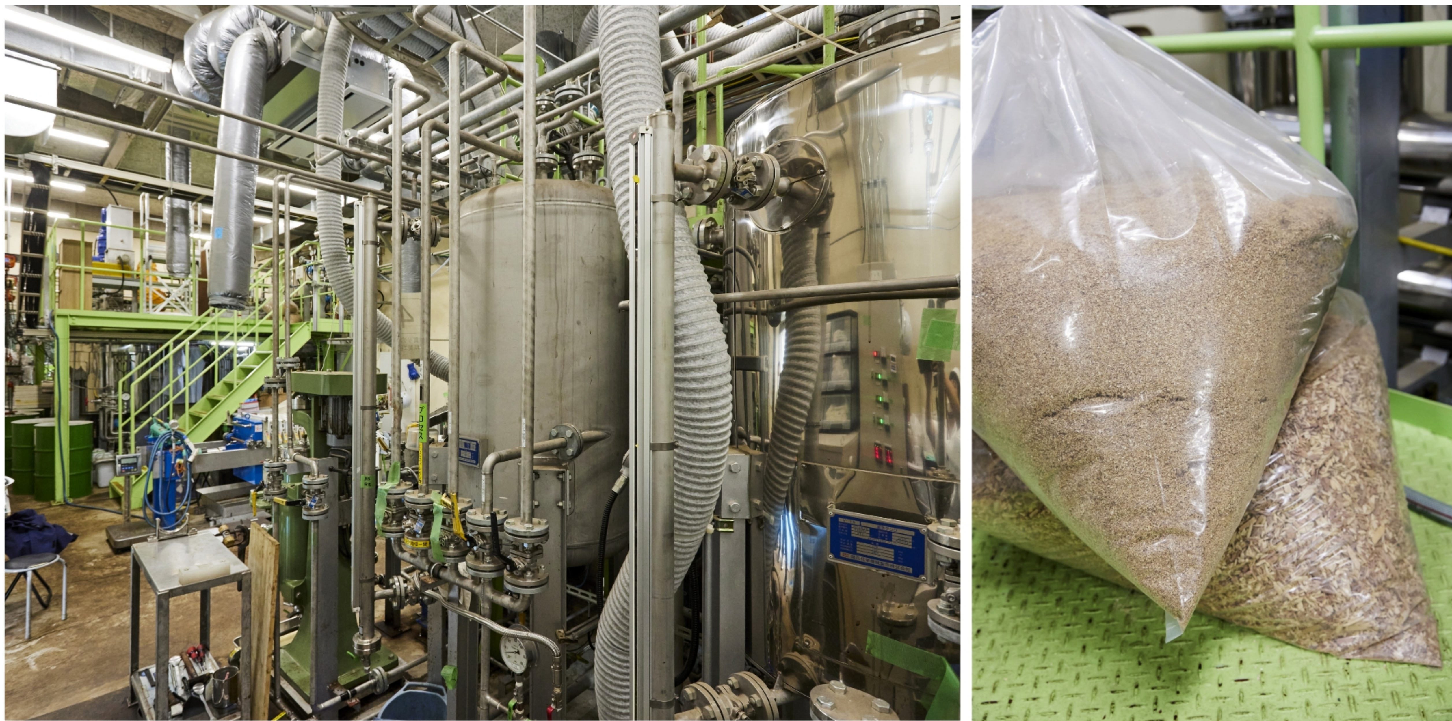
森林総合研究所内にあるベンチプラント。原材料のチップやおが屑から、約36パーセント相当の改質リグニンが取れるという。例えば50キログラムなら18キログラムが精製される。
