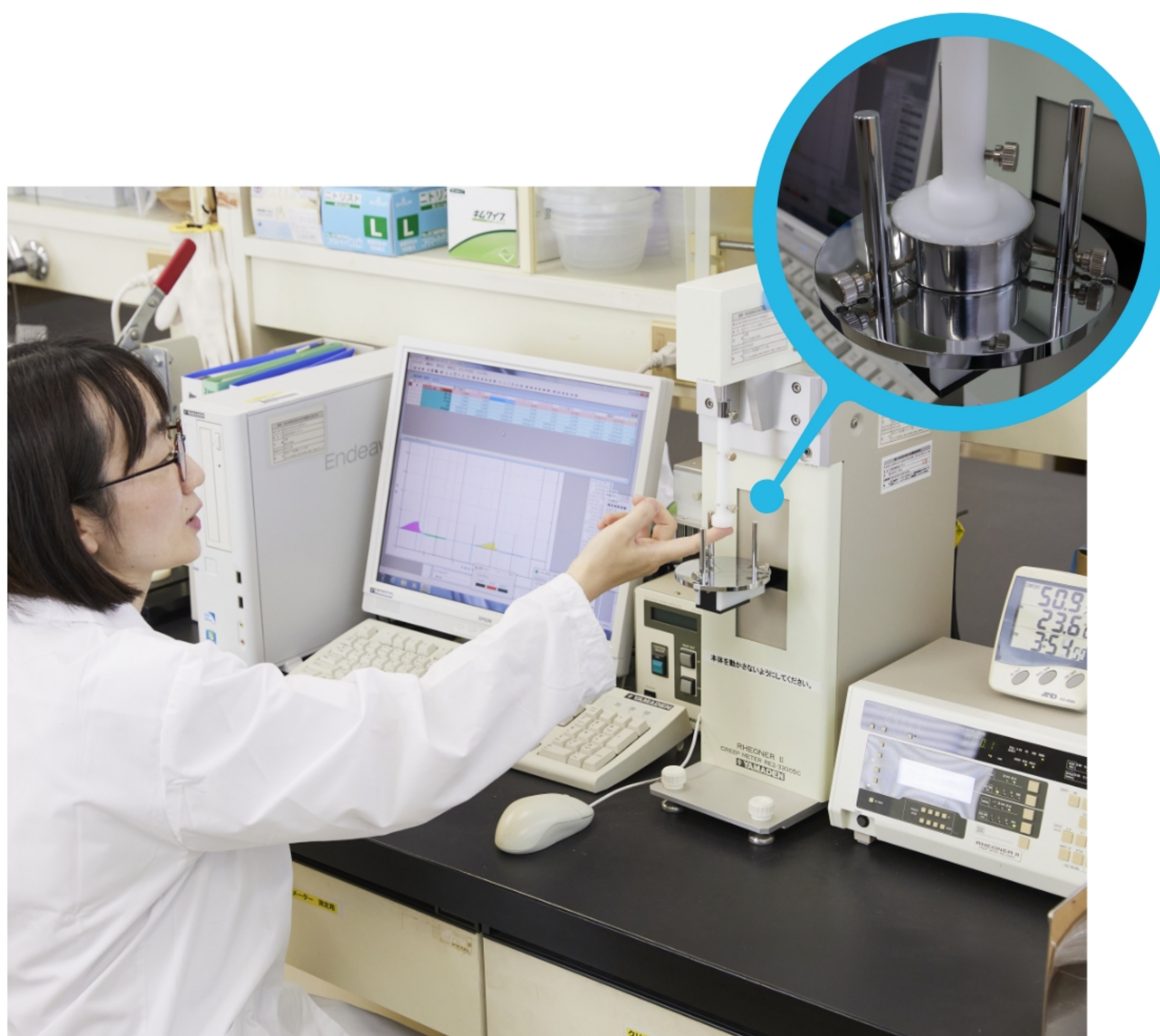
専用の測定器でさまざまな米粉用品種から作る米粉ゼリーの物性を繰り返し試験。同じアミロースでも品種により性質が異なるため、それぞれの性質を把握し精査してブレンド率を決めています。
